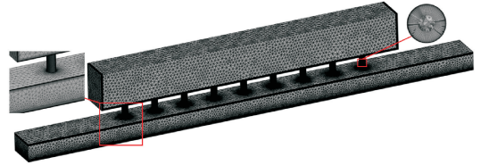
图 10 平板阵列冲击结构的计算域网格
