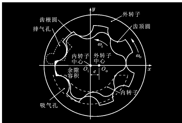
图1 未修正型线的啮合示意图
