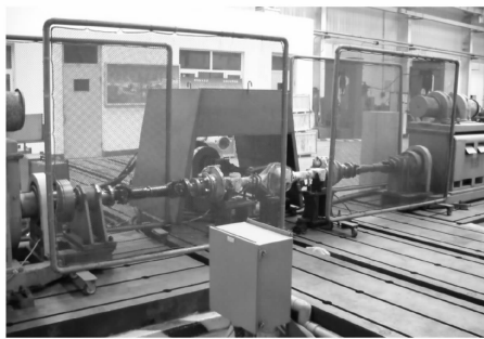
图13 驱动桥台架试验
