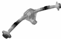
图 3 驱动桥总成的计算一阶弯曲振型
