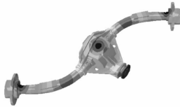
图 4 驱动桥总成的计算二阶弯曲振型
