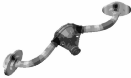
图 5 驱动桥总成的计算三阶弯曲振型
