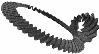
图 10 主减速器准双曲面齿接触对
