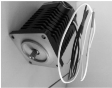
图 8 双余度稀土永磁无刷电机样机
