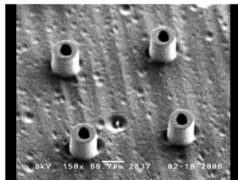
图4 无补偿过程加工中间结果的扫描电镜照片
