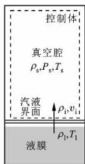
图2 薄膜渗透理论下实验系统的计算模型
