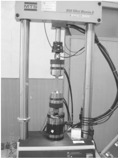
图 2 MTS-858 疲劳试验机和加载情况
