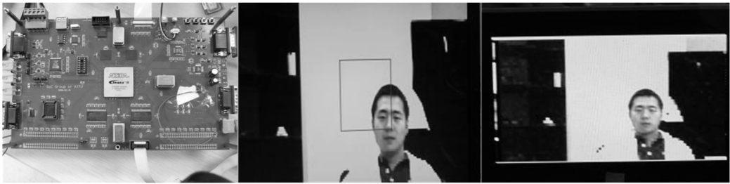
(a)验证平台 (b)液晶显示器显示效果 (c)液晶屏面板上的屏显示效果 图 4 非均匀采样硬件系统
