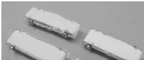
(b) 填充 CPC 后的复合人工骨 图 1 钛-CPC 复合人工骨
