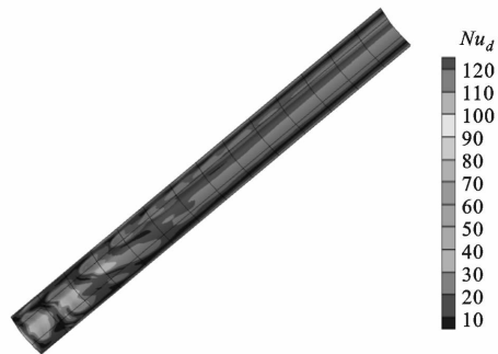
图8 射流孔径为1 mm时靶面上 Nu_d 分布
