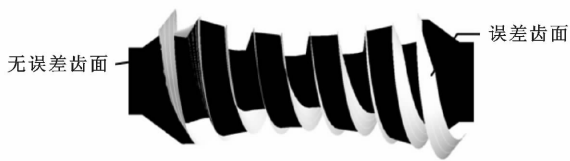
图 12 \Delta c_2 = \pm 2 mm 时蜗轮滚子偏距误差对齿廓的影响
