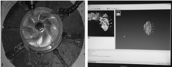
(a) 叶轮加工 (b) 叶轮曲面重构
