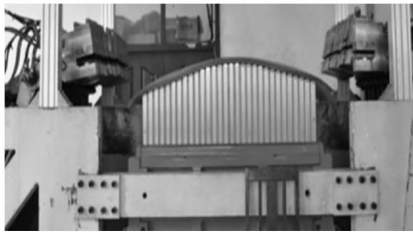
图2 基于多点模具的柔性夹钳拉形装置
