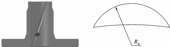
(a)螺旋油槽结构 (b)螺旋油槽截面形状
