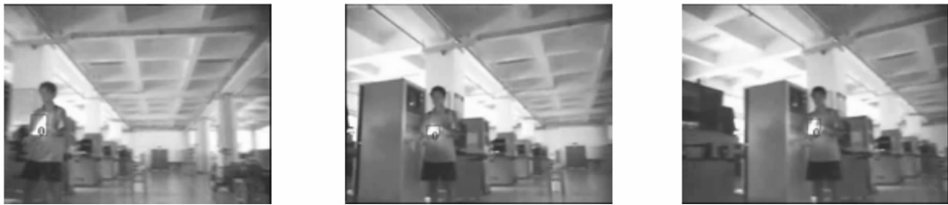
(a)火焰运动到视场左边 (b)云台左转 (c)把运动火置于水平中心
