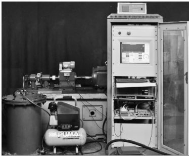
图 7 滑靴卡盘和球碗的试验装置
