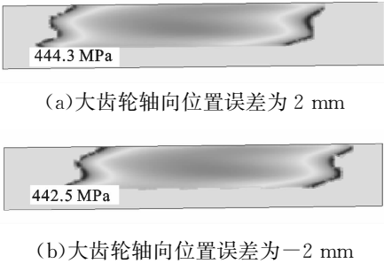
图 11 大齿轮轴向位置误差对啮合印痕的影响
