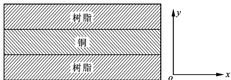
图 3 端部绕组线棒材料成分分布
