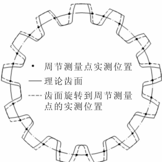
图 3 齿面旋转到实测位置的齿轮模型
