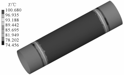
图 6 传统结构屏蔽电动机定子屏蔽套温度分布
