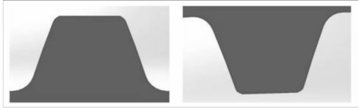
图 4 单齿对理想齿廓修形模型正视图
