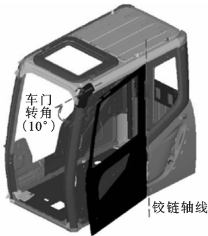
图 3 挖掘机车门运动边界条件
