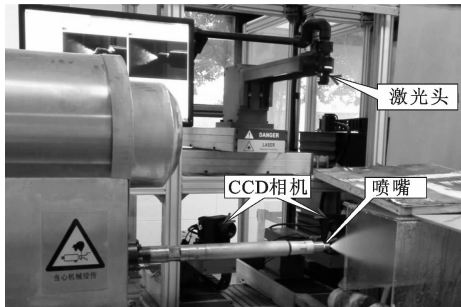
图8 流场测试中部分设备及实验过程
