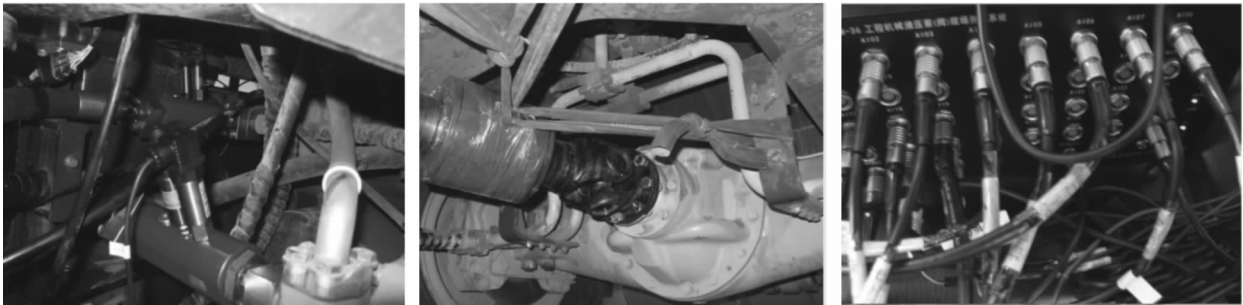
(a)压力、流量传感器 (b)环形变压器供电的应变式扭矩传感器 (c)多通道数据采集仪
