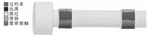
图 11 8 000 r/min 时转子拉杆凸肩接触状态
