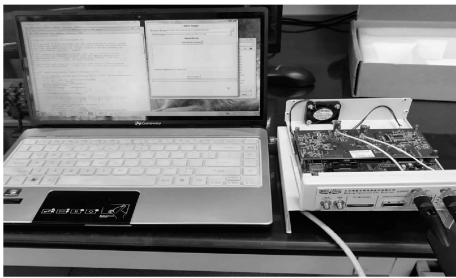
图 4 使用 USRP2 平台搭建的接入节点
