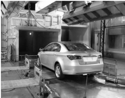
图 3 车辆前端总压验证试验图
