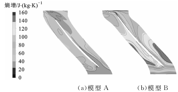
图 8 两种模型近端工况下叶轮 90%叶高截面的熵增分布
