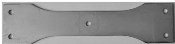
图 5 制备有 PVD 薄膜传感器的激光冲击强化试验件
