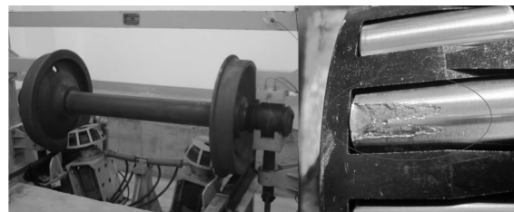
图 11 轮对跑合实验台及故障轴承
