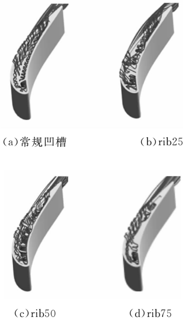
图 10 4 种凹槽冷却气流流线分布
