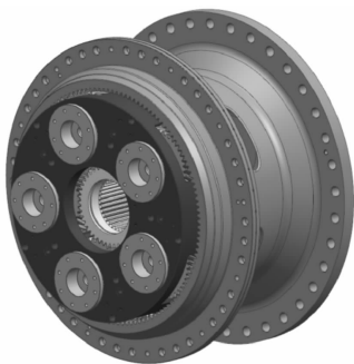
图 2 某型 GTF 齿轮减速器结构示意图
