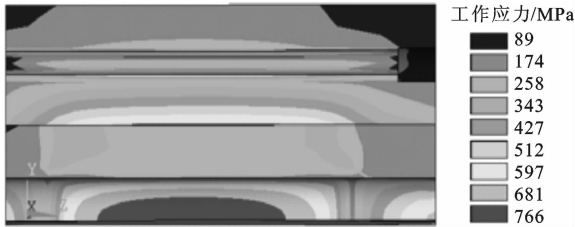
图 12 实际工况下的扁挤压筒工作应力分布云图
