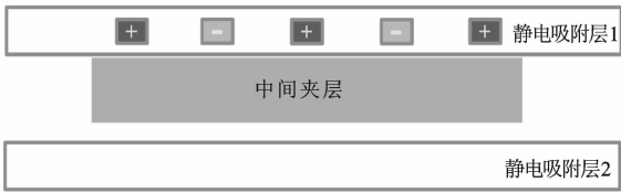
(b) 单层加电原理
