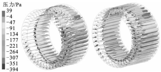
(a)仿鱼形叶片叶轮区 (b)单圆弧叶片叶轮区
