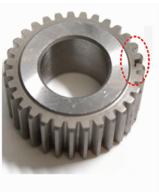
(b)齿根裂纹 图 13 行星轮裂纹故障实验平台
