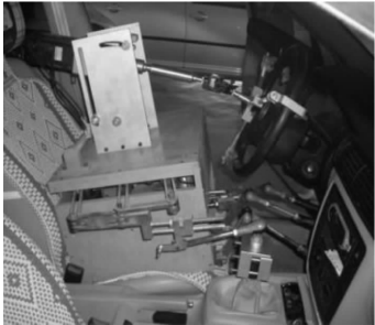
图 9 安装在试验车辆上的驾驶机器人
