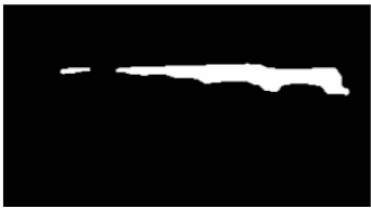
(d)形态学闭操作后提取到的完整损伤区域
