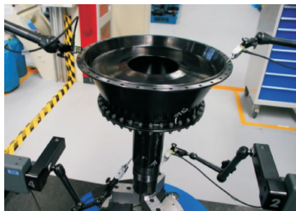
图 1 测量转子配合面
