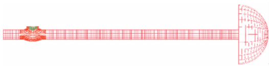
图 5 DN200 钢管+截止止回阀的系统模型网格
