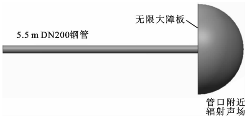
图 2 DN200 钢管管路系统简化模型
