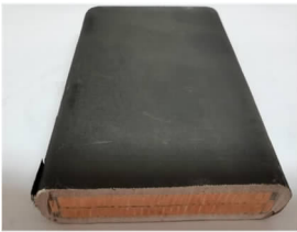
图 9 实验用定子线棒纵向图 Fig. 9 Longitudinal view of stator bar for test
