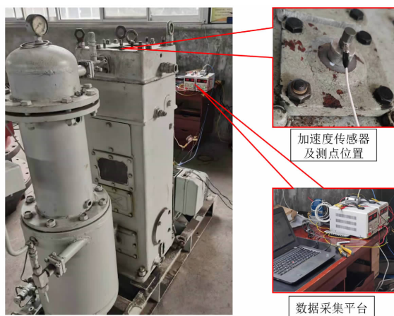
图4 往复式压缩机故障模拟实验台
