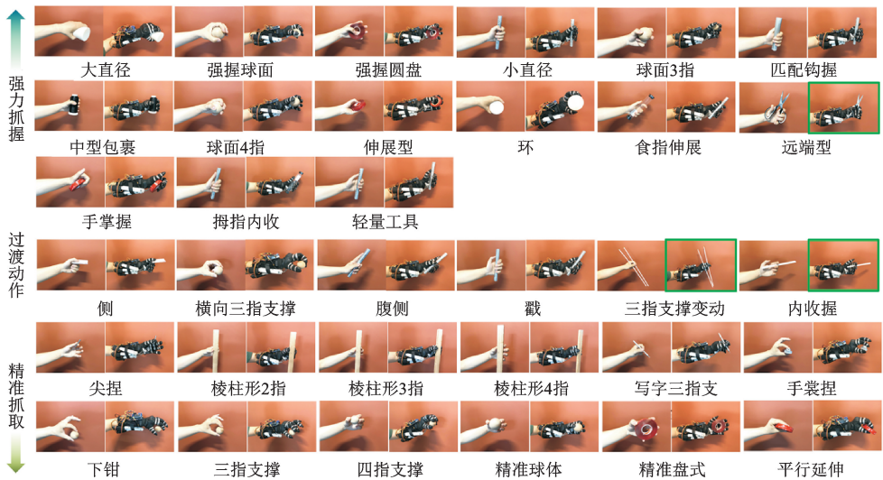
图 16 采用 Feix 分类法测试 33 种不同的抓取类型
