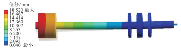
(a) 第一阶临界转速为 3\,120\,\text{r} \cdot \text{min}^{-1} (外伸端摆振)
