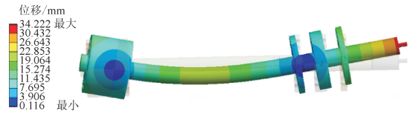
(c) 第三阶临界转速为 30\,120\,\text{r} \cdot \text{min}^{-1} (跨内一阶弯曲)
