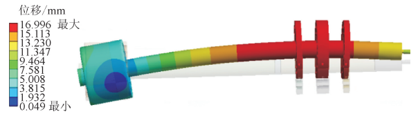
(b) 第二阶临界转速为 20\,574\,\text{r} \cdot \text{min}^{-1} (右端摆振)
