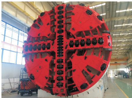
图 2 某型土压平衡盾构机刀盘面板结构 [25]
