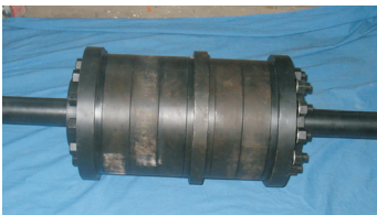
图 4 拉杆转子模态试验实物图 [28] Fig. 4 Modal experiment of a bolt-fastened rotor [28]
