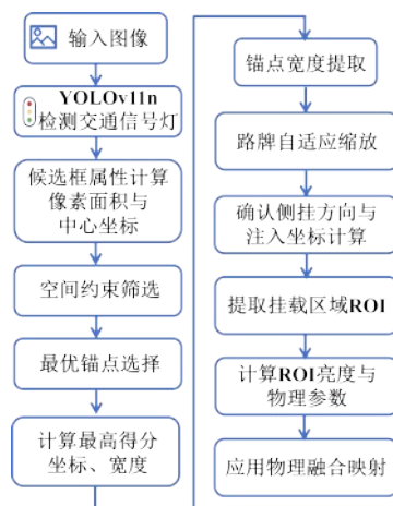
图4 YOLO检测器物理定位流程图
