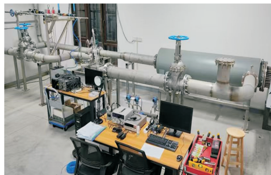
图 1 叶片冷却实验系统
