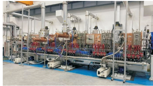
图 2 西安交通大学 AB-BNCT 装置 RFQ 加速器实物照片
