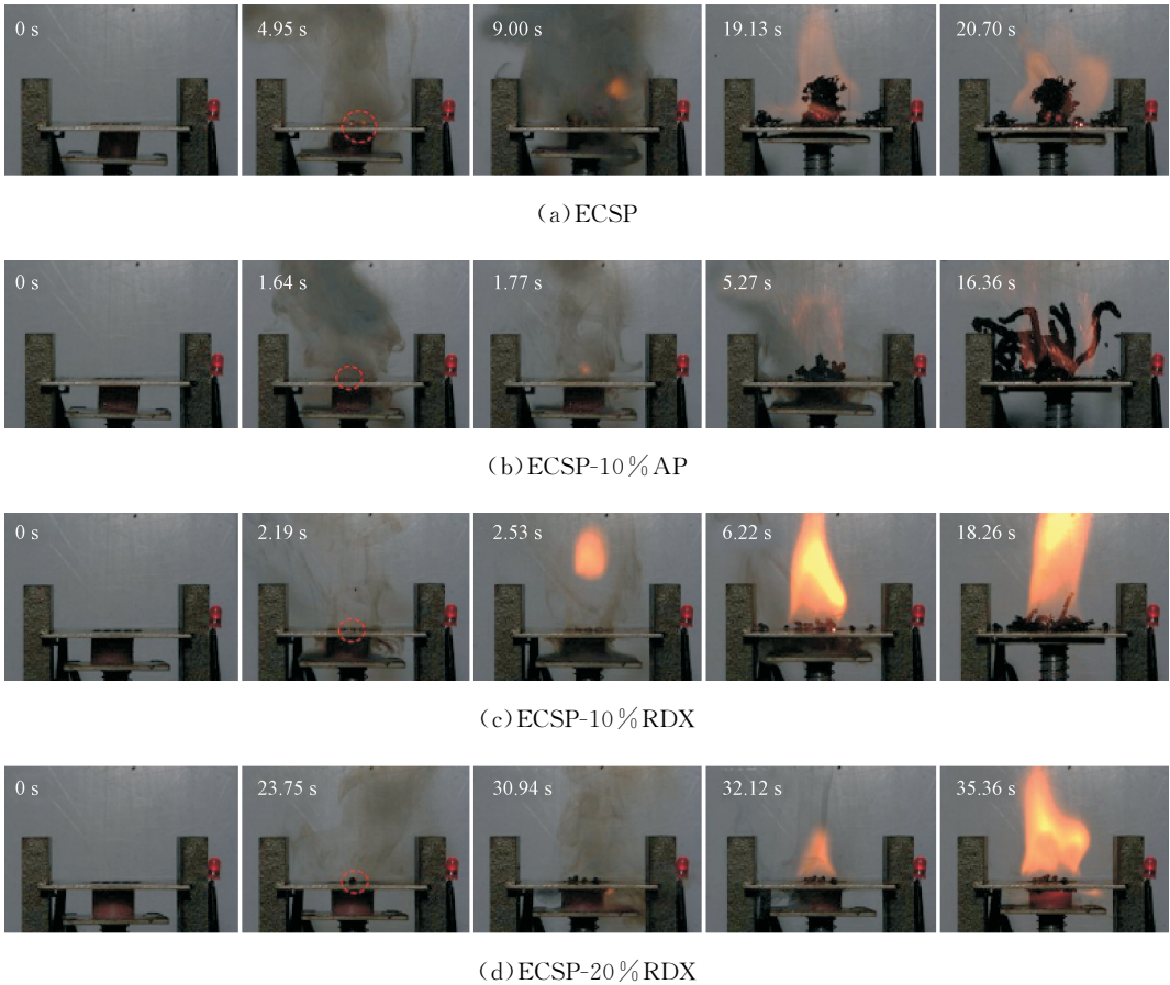
图 9 4 种样品燃烧过程演化图像 Fig. 9 High-speed images of four different samples
